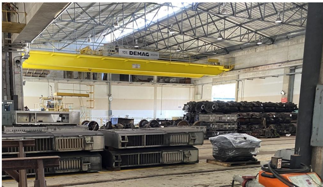
Foto 12-27: Ponte rolante DEMAG com 15T de capacidade
