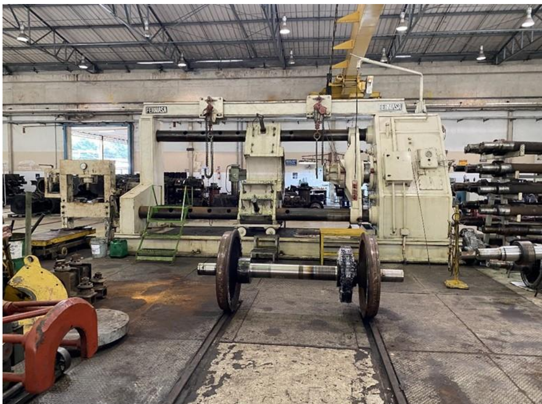
Foto 12-23: Prensa Hidráulica de Eixar Rodas
