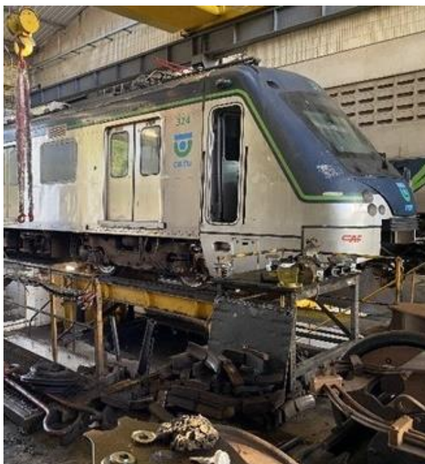
Foto 12-21: Mesa Falsa para retirada de Truques
