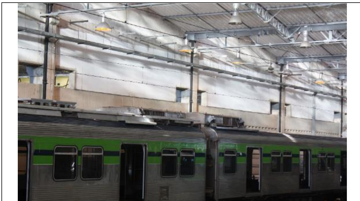
Foto 6-4: Unidade condicionadora sobre o teto
