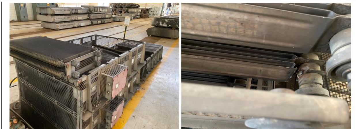
Foto 6-7: Manutenção dos resistores de frenagem
