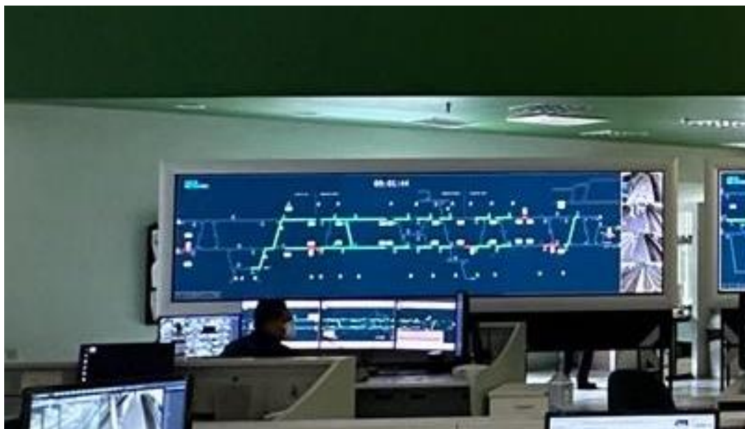
Foto 11-33: Console de Tráfego da Linha Sul – Elétrica
