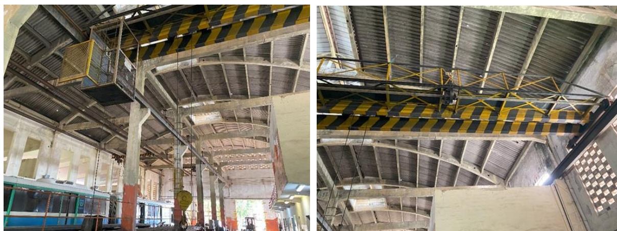
Foto 12-59: Ponte rolante com capacidade 5T
