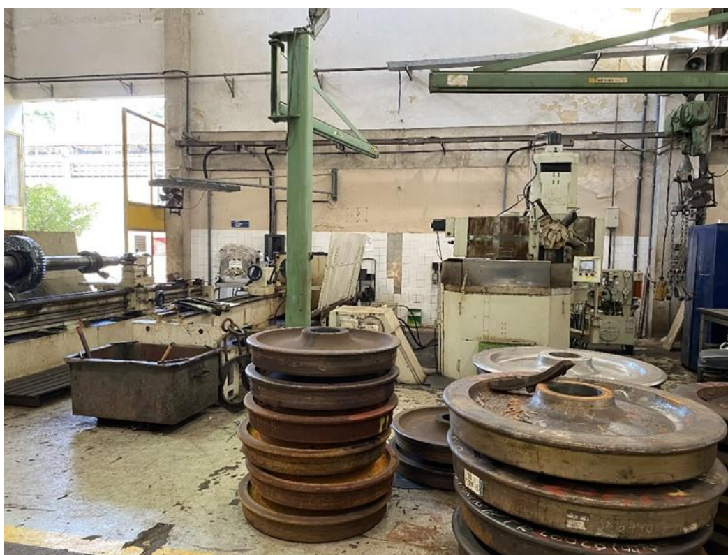
Foto 12-24: Equipamentos para usinagem pesada de rodeiros e eixos
