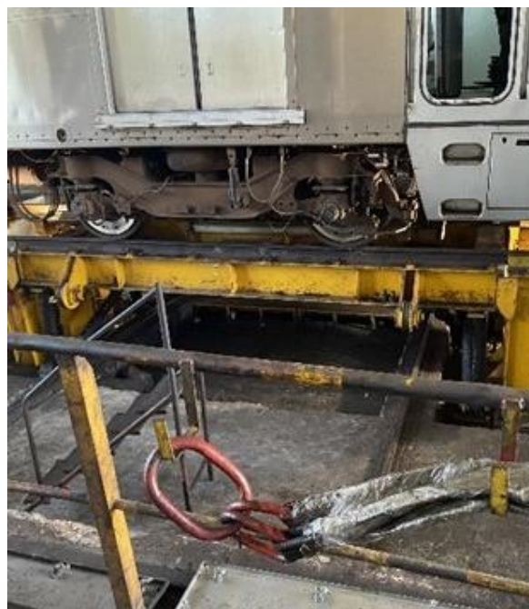
Foto 12-22: Mesa Falsa para retirada de Truques
