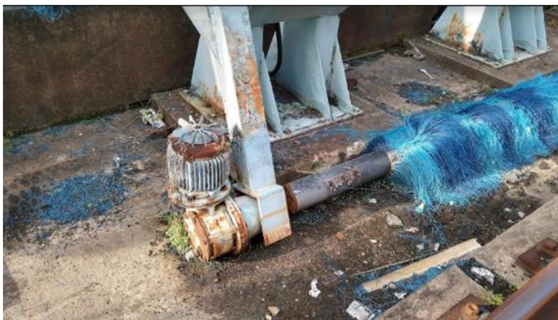
Foto 12-48: Bloco 11 – Máquina de lavar trens inoperante e parcialmente desmontada
