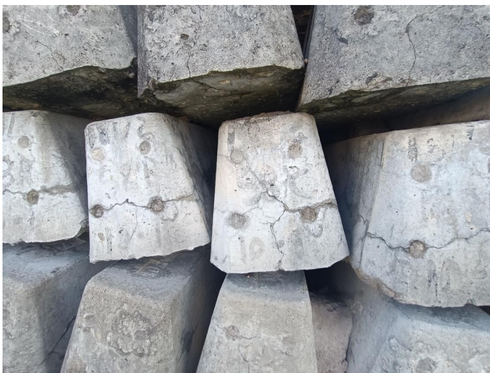
Foto 2-15: Estoque de dormentes monoblocos novos, na Estação Recife, comprometidos pela Reação Álcali Agregados (RAA).
