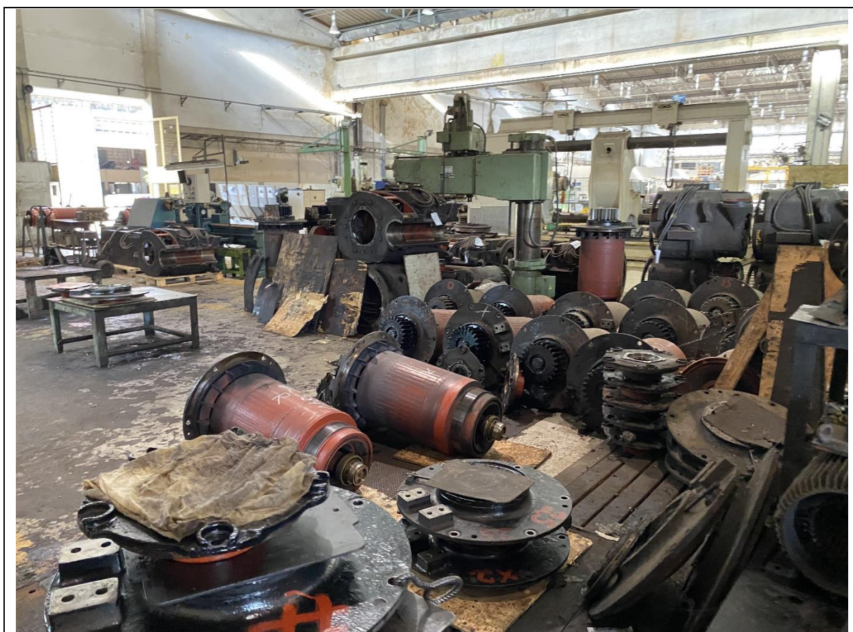
Foto 6-8: Manutenção dos motores de tração
