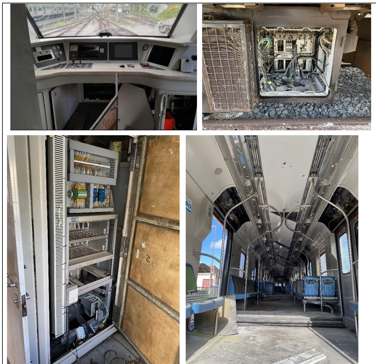
Foto 6-18: TUE 27, da frota CAF, Vandalizado e Canibalizado
