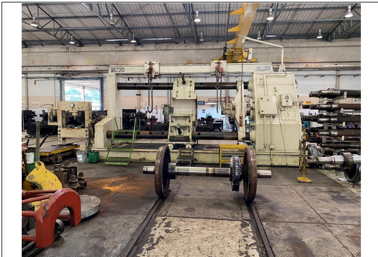
Foto 6-9: Usinagem de eixos e rodas
